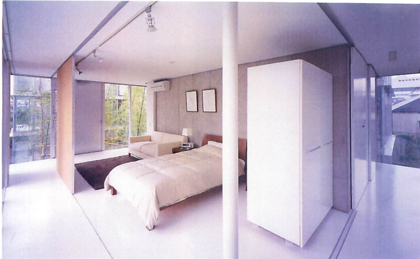
南側住棟の3階住戸（Cタイプ）。中央の耐震壁の向こう側に居室と水まわりを配置する。4周ガラス張りとなっており、二重の可動建具（茶色の間仕切り）と可動家具（白い収納）で空間をフレキシブルに使うことができる。主な可動建具はパーティクルボード製のフラッシュ戸で、レールから取り外せば移設が可能
